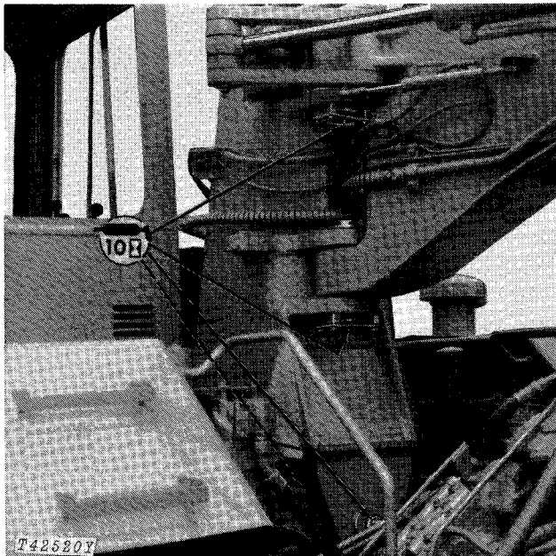
Fig. 16-Oscillation Hitch Pivots (4 points)
