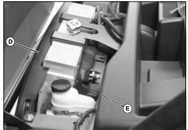
b. Intake screen (D), and radiator cooling fins (E).
